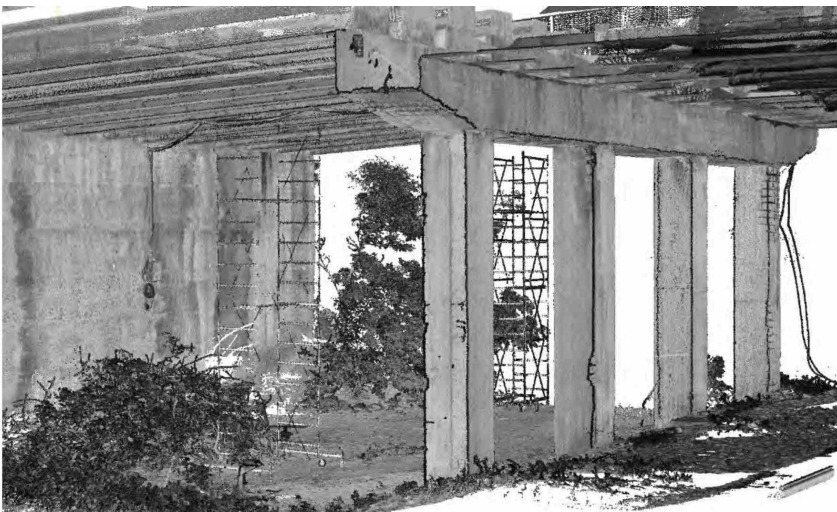
Figura 2 - Un esempio di digitalizzazione per il monitoraggio dei manufatti: il rilievo di un viadotto eseguito con tecniche integrate topografia/GNSS/lidar
